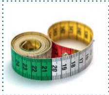
٥- المقياس الشريطي: وهو شريط عليه علامات القياس بالسنتيمتر والإنش، ويُستخدم لأخذ قياسات القطعة المحاكاة حتى ينتج بشكل لائق ومناسب.
