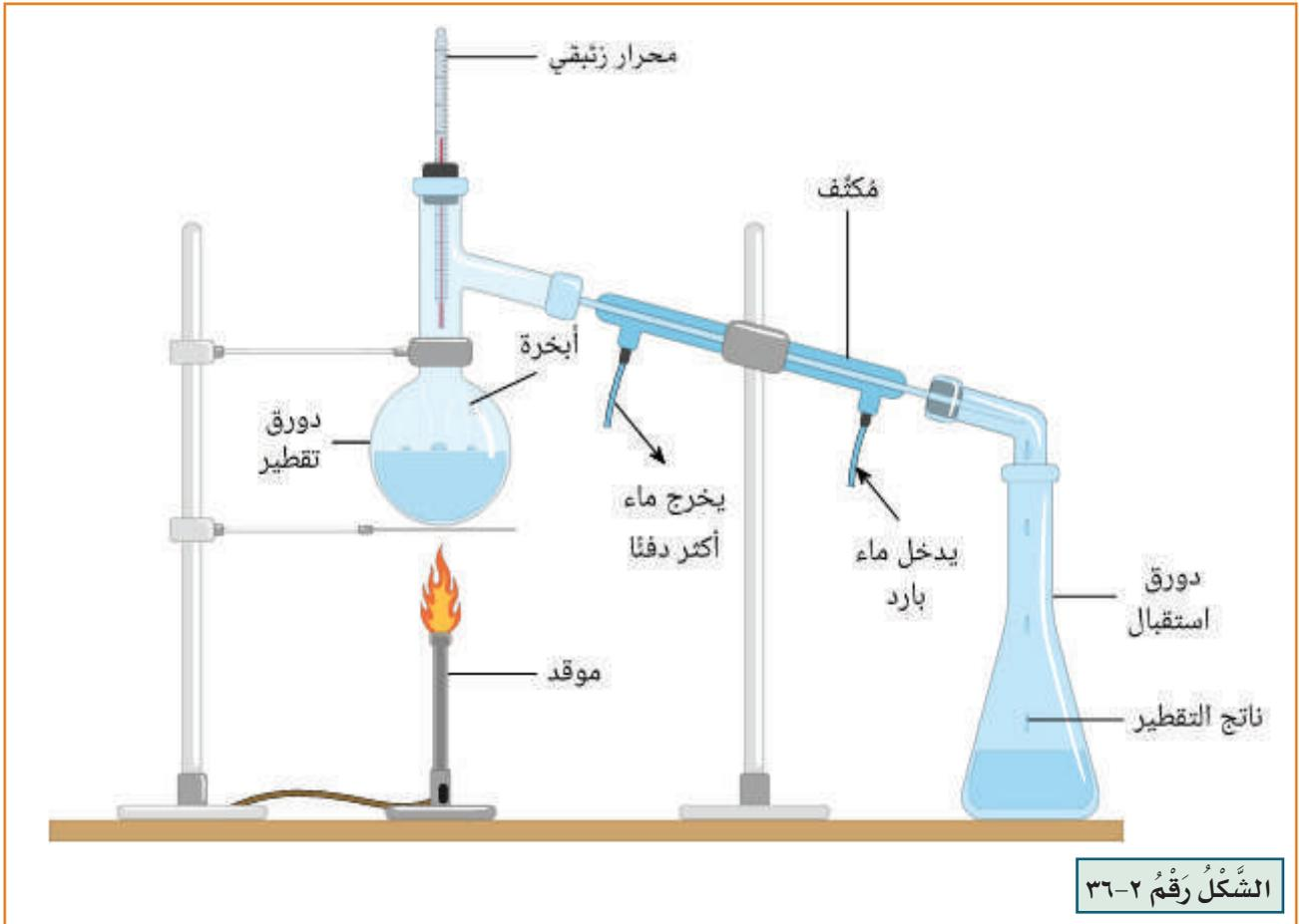
اعلاه الشكل (٢-٣٦) لإعداد التقطير البسيط. ويجب أن يكون رأس المحرار الزئبقي أمام فتحة المكثف مباشرة. وهذا يعني أن قراءة درجة الحرارة ستكون انعكاساً دقيقاً لدرجة حرارة البخار قبل دخوله مباشرةً في المكثف (وليس دورق التقطير، الذي قد يكون أكثر سخونة قليلاً).
