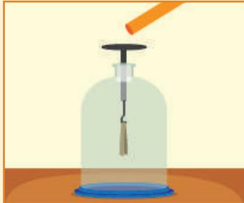
١- قَرِّبْ طرف الساق من الكاشف الكهربائي، كما موضح في الشكل، ماذا ألاحظ.
