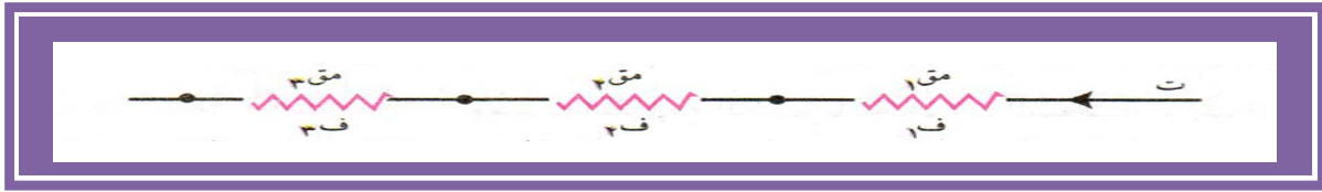
شكل (٢٨) ربط المقاومات على التوالي
